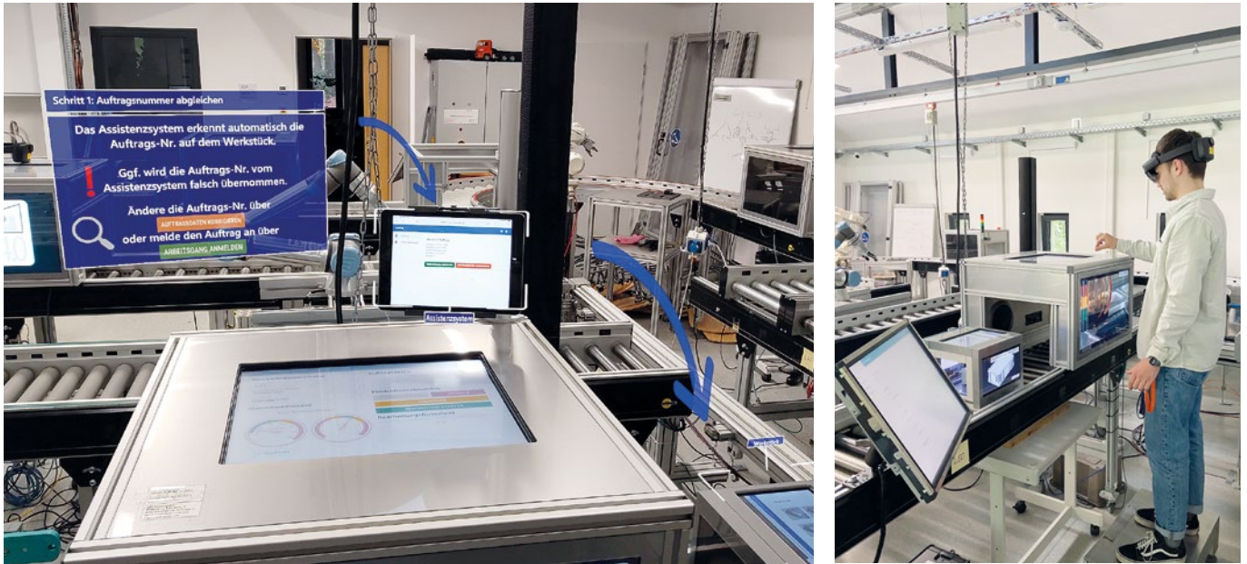
Bild 1: Produktionsumgebung während des Lernens und der Anwendung (links) und Visualisierung der AR-Anweisungen (rechts).
